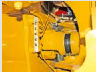
La centralisation du graissage regroupe à portée de main les graisseurs difficiles à atteindre. Le tableau de lubrification extrêmement pratique permet de s'assurer qu'aucun point de graissage n'a été oublié.
